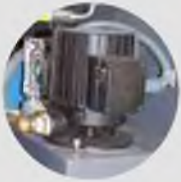
Soğutucu Pompası Coolant Pump
