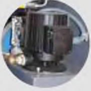
Soğutucu Pompası Coolant Pump
