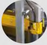
Kol Mengene ile Hareket Etme Vice and Arm Moving Together
