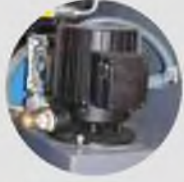
Soğutucu Pompası Coolant Pump
